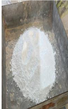
الشكل 1. يبين التركيب البلوري ومسحوق ثاني أكسيد التيتانيوم
