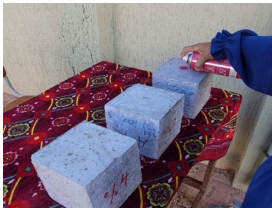
الشكل 5. يبين رش المكعبات الخرسانية بالصبغة
