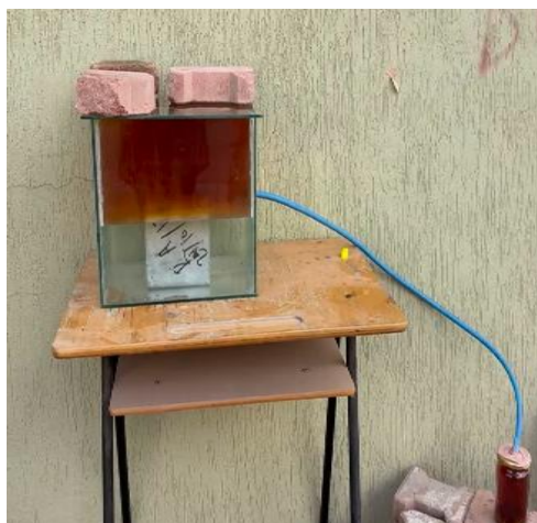
الشكل 3. يبين تعرض مكعب الخرسانة لغاز ثاني أكسيد النيتروجين ( NO_2 )
