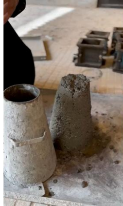
الشكل 2. يبين اختبار الهبوط للخرسانة الطازجة
